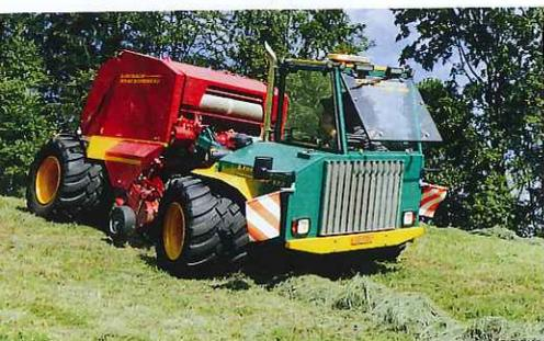
Diese selbstfahrende Rundballenpresse hat die Lisibach Maschinenbau AG selbst entwickelt und gebaut. Vierradantrieb, 130 PS und 6,5 t Eigengewicht sorgen für ordentlich Power.
