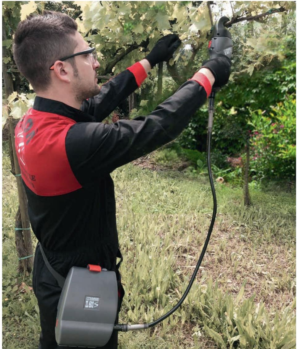
Appareil à accus pour attacher la vigne permet de réaliser plus de 60 attaches à la minute.
