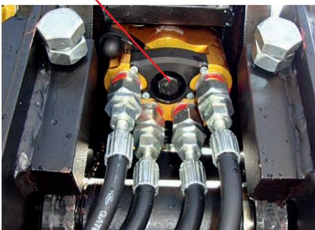
Mit dieser Anpassung steht der Verriegelungshebel nirgends an einem Stahlträger an und die Kupplung kann, wenn nötig, mit Hilfe eines Schraubenschlüssels verriegelt werden.
