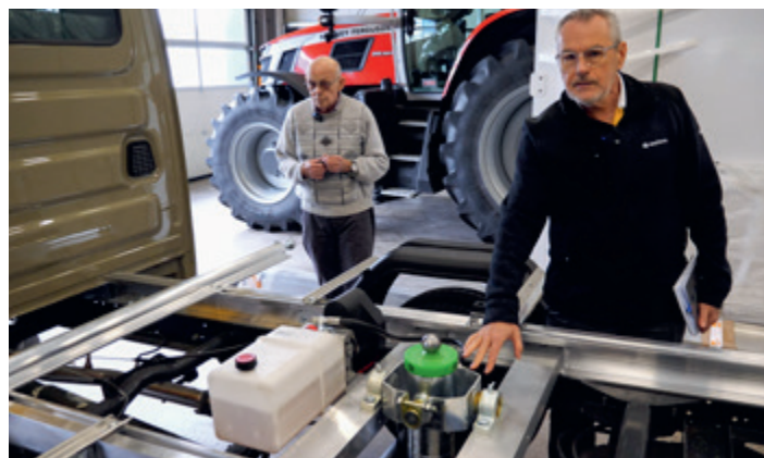
forrer Elektroaggregat und Teleskopzylinder mit optimiertem Kardanring
