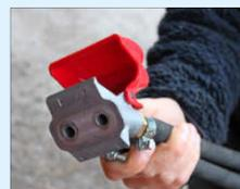
Duomatik-Druckluft-Anschluss. (Bild: dha)
