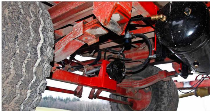
Ein Wagen mit Kombi-Zylinder für die Betätigung mit beiden Systemen. (Bild: Daniel Hasler)
