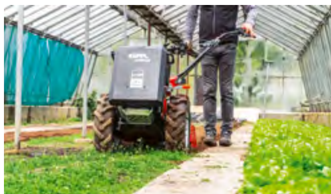
Un «Kompakt Comfort eDrive» («CCE») en configuration moto-culteur: ses performances tout électriques conviennent aussi pour des travaux à l'intérieur, comme dans ces serres.
