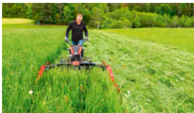
Karl Köppl fauche de l'herbe haute avec le monoaxe électrique «Kompakt Comfort eDrive» («CCE») équipé de la barre de coupe en portique «KPE», à faible niveau de vibrations.
