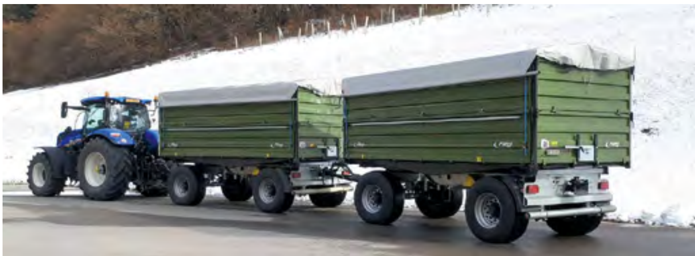
Der Test-Anhängerzug: Traktor New Holland «T7.270» mit hydraulischer Zweileiter-Bremse ab Werk und zwei Drehschemel-Anhänger Fliegl «DK180» (je 18 t zulässiges Gesamtgewicht) mit aufgebautem «H2L»-Bremssystem von Paul Forrer. Bild: Paul Forrer AG
