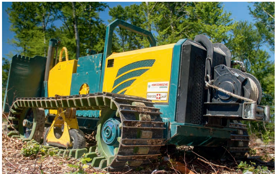
Yanmar-Motor und Brevini Fluid Power-Komponenten: eine interessante Kombination im Forstslepper «HFR 504 Plus».
