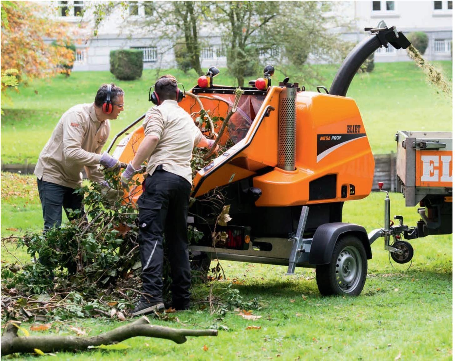
Avec le nouveau broyeur **Mega Prof** ELIET met sur le marché une machine polyvalente qui sera une aide précieuse pour les entreprises de jardiniers paysagistes et les communes. Le système unique de broyage (principe de la hache ELIET) combiné avec un puissant moteur turbo Diesel de 33 CV confèrent à ce broyeur des capacités étonnantes capables de broyer des branches jusqu'à 15 cm de diamètre.
