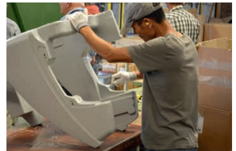
Entgraten der gesinterten Fahrgestelle
