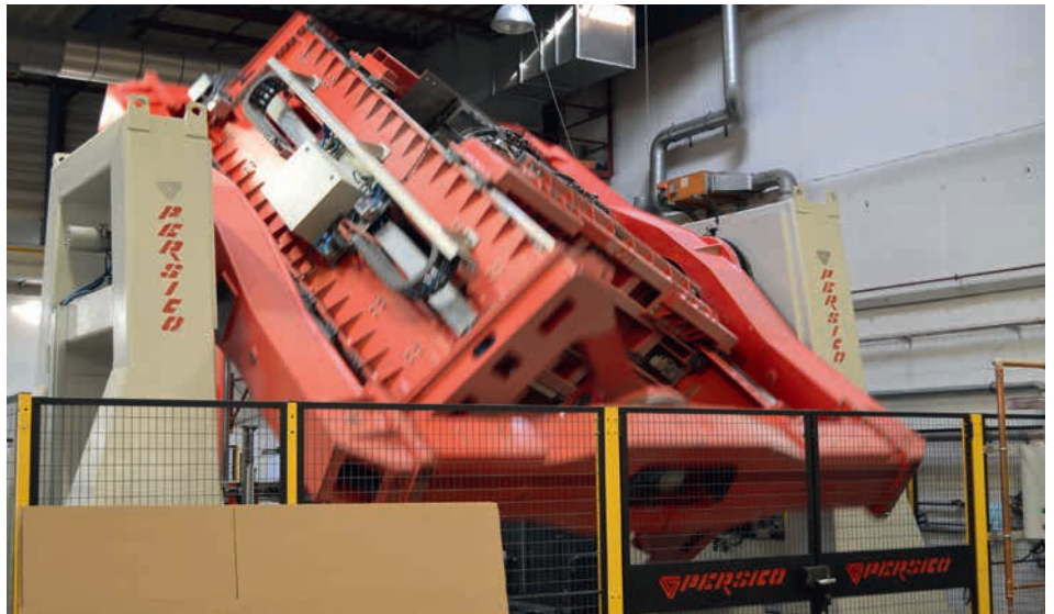
(2) Vollautomatische Rotationssinter-Maschine im 24-Stunden-Betrieb
