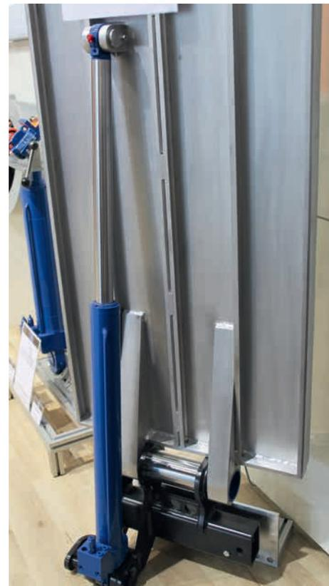
Vérin de levage de rampe : sur pression du bouton, la rampe est levée et assurée.
