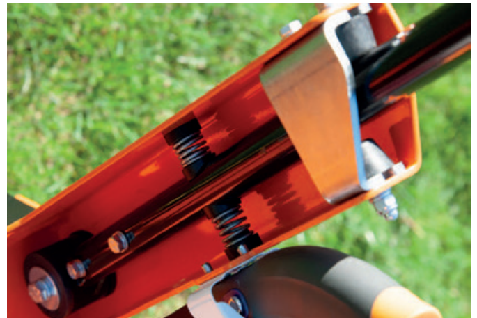
Die Vibrationsdämpfung im Lenkholm sorgt für Bedienkomfort
