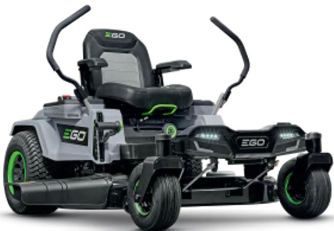
Der neue EGO Zero-Turn-Rasenmäher Z6 – der weltweit erste Aufsitzmäher mit einem plattformübergreifenden Wechsel-Akkusystem. Bis zu sechs Arc-Lithium-Akkus kann der Z6 aufnehmen. Mit einer Leistung entsprechend 22 PS und einer Höchstgeschwindigkeit von knapp 13 km/h mäht der Z6 eine Fläche bis zu 10.000 m<sup>2</sup> mit einer einzigen Aufladung.
