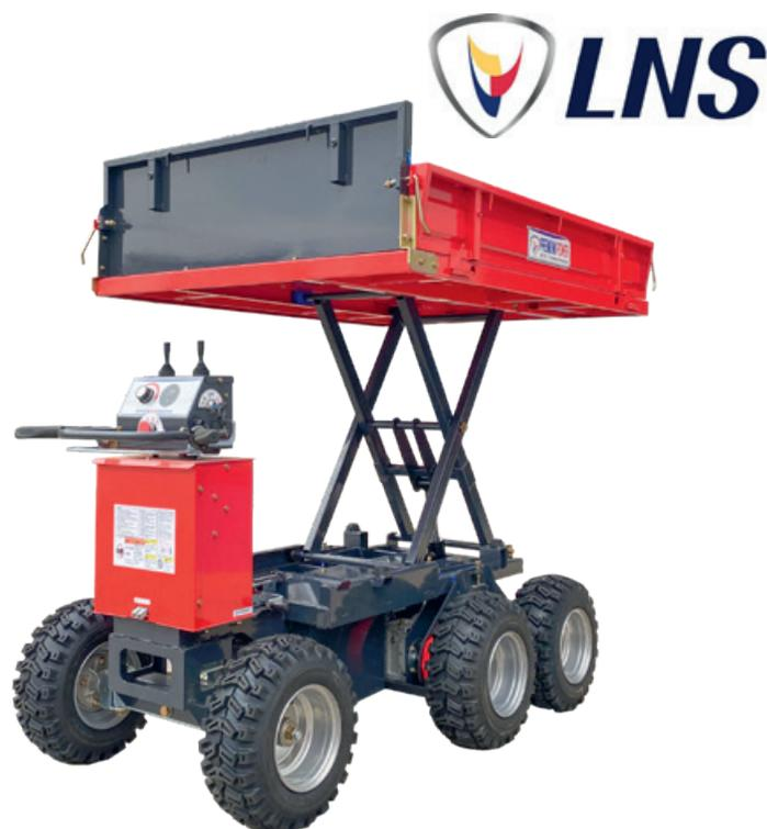
Es gibt viele gute Gründe, die für den LNS Akku-Transporter mit dem LNS Power Premium Akku sprechen: Grosse Leistung und wenig Wartung. Sie sind als Rad- und Raupentransporter erhältlich. Mit einer Nutzlast von bis zu 500 kg und einer Laufzeit von bis zu 8 Stunden, sind die Transporter dank Raupenantrieb oder 6x4 Radantrieb auch im Gelände souverän unterwegs.
