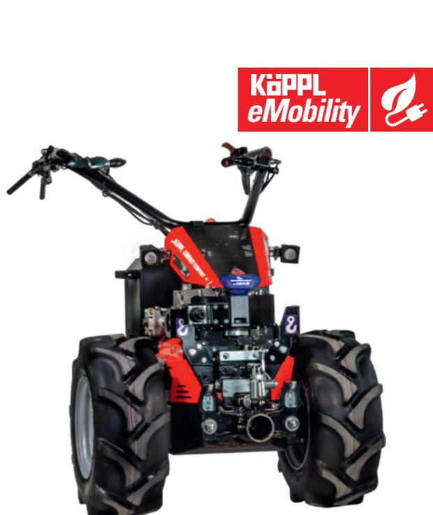
Für den vollelektrischen Einsatz bietet Köppl als Einstiegsgerät den Kompakt Easy (CEE) und als Vollprofi den Kompakt Comfort (CCE). Der CEE startet mit einer Spitzenleistung von 3,3 kW mit bis zu 6 km/h. Das Leistungspaket CCE kann mit einer Spitzenleistung von 7,3 kW, betrieben werden. Vorwärts erreicht der CCE eine Geschwindigkeit bis zu 8 km/h. Für die Leistung sorgt das Köppl Akku-Paket mit einer Kapazität von 150- respektive 210 Ah.
