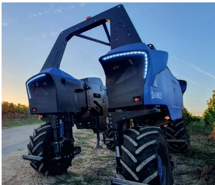
Robot viticole ViTiBOT avec entraînement E-Drive
