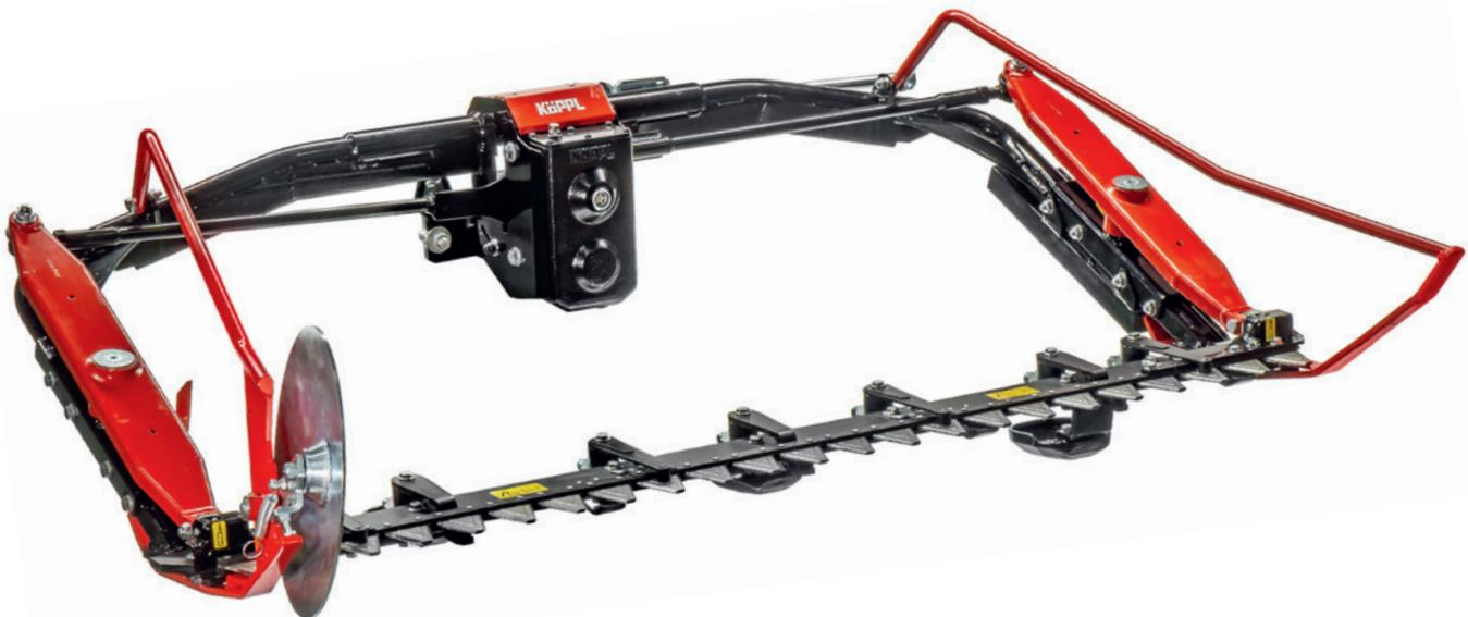
Les **disques de séparation de l'herbe** montés librement sur des paliers et tendus par des ressorts favorisent l'écoulement du fourrage et de l'herbe même lors de grandes quantités. Ces disques qui tournent librement évitent la formation de monticules et guide le fourrage hors de la prochaine ligne de coupe. La forme arrondie améliore le passage de l'herbe sur les côtés et évite au fourrage de s'accrocher à la barre de coupe.
