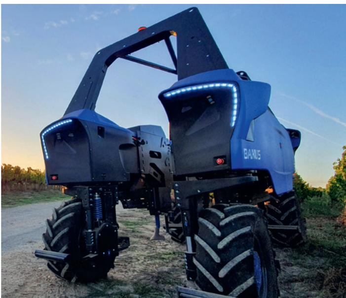
Weinroboter VITIBOT mit E-Drive Antrieb
