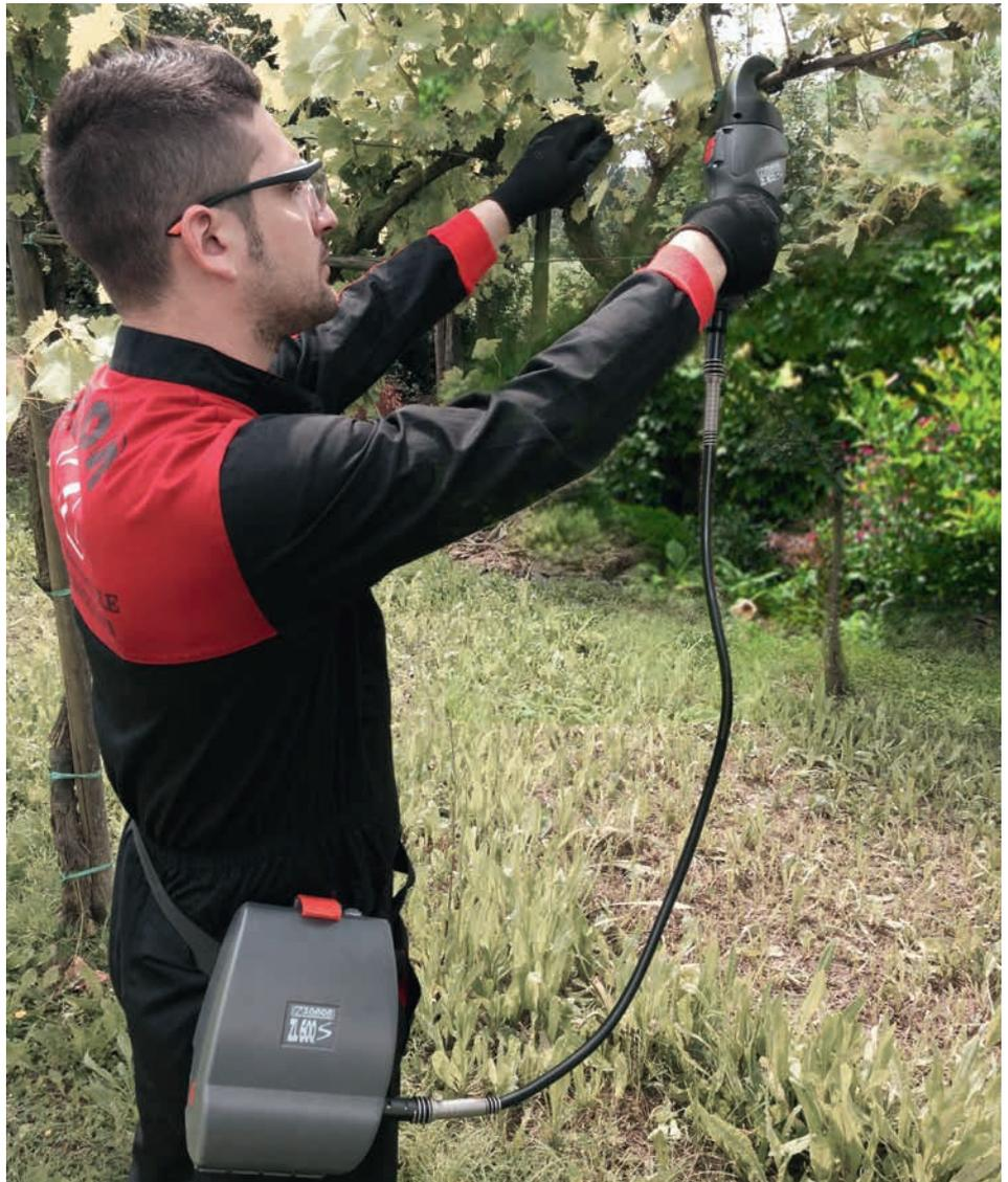
Akku-Rebenbindegerät mit mehr als 60 Bindungen pro Minute.
