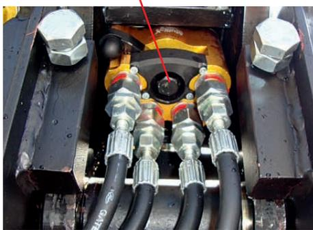
Avec cette adaptation, le levier de verrouillage n'entre en contact avec aucun élément du châssis et le coupleur peut, au besoin, être déverrouillé à l'aide d'une simple clé six pans.
