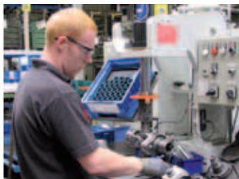
**4.** Nach parallelen Arbeitsschritten wie die Fertigung der Kreuzgarnitur und der Gabel erfolgt abschliessend die Gelenkmontage.
