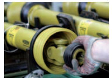
**6.** Bevor die Gelenkwelle an den Handel ausgeliefert wird, wird sie noch ein letztes Mal auf ein perfektes Zusammenspiel überprüft.
