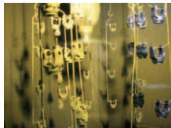
**5.** Mit der umweltfreundlichen Zwei-Komponenten-Lacktechnologie setzt Walterscheid seit 2005 neue Standards beim Härtegrad der Lackoberfläche. Zusätzlich werden die Mitarbeiter durch den Lack auf Wasserbasis weniger Schadstoffen ausgesetzt.
