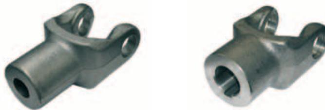
**2.** Der erste Arbeitsschritt ist das Einbringen der Bohrungen. Hier ist eine exakte Ausführung alles entscheidend. Schon eine leichte Verschiebung der horizontalen Achse im Schnittpunkt zur vertikalen Achse kann später die Laufruhe und Lebensdauer beeinflussen.
