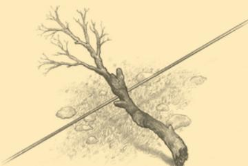
2.2 Engagez maintenant le levier de roue libre et tendez soigneusement le câble. Vous pouvez ensuite commencer avec le treuillage. Pour les treuils électriques il est recommandé de laisser tourner le moteur du véhicule afin de ne pas décharger la batterie.
