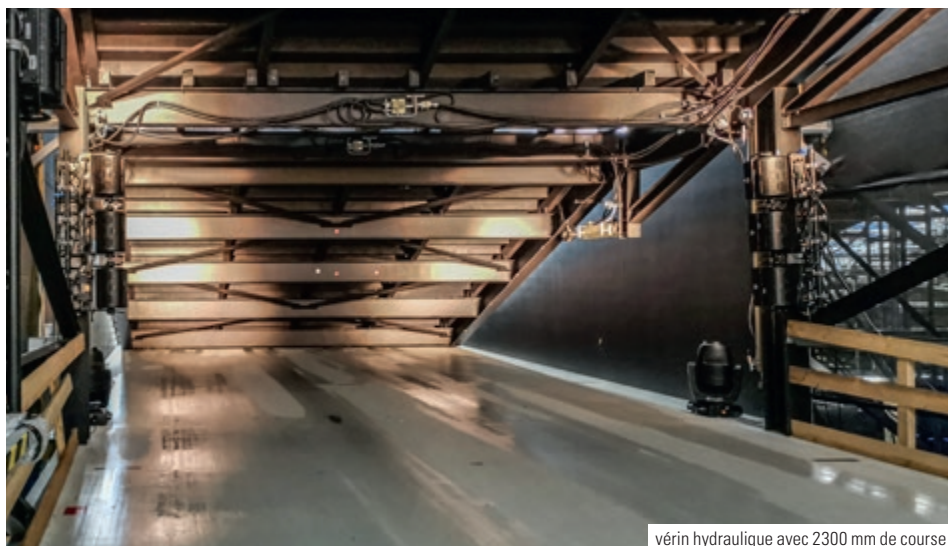
vérin hydraulique avec 2300 mm de course
