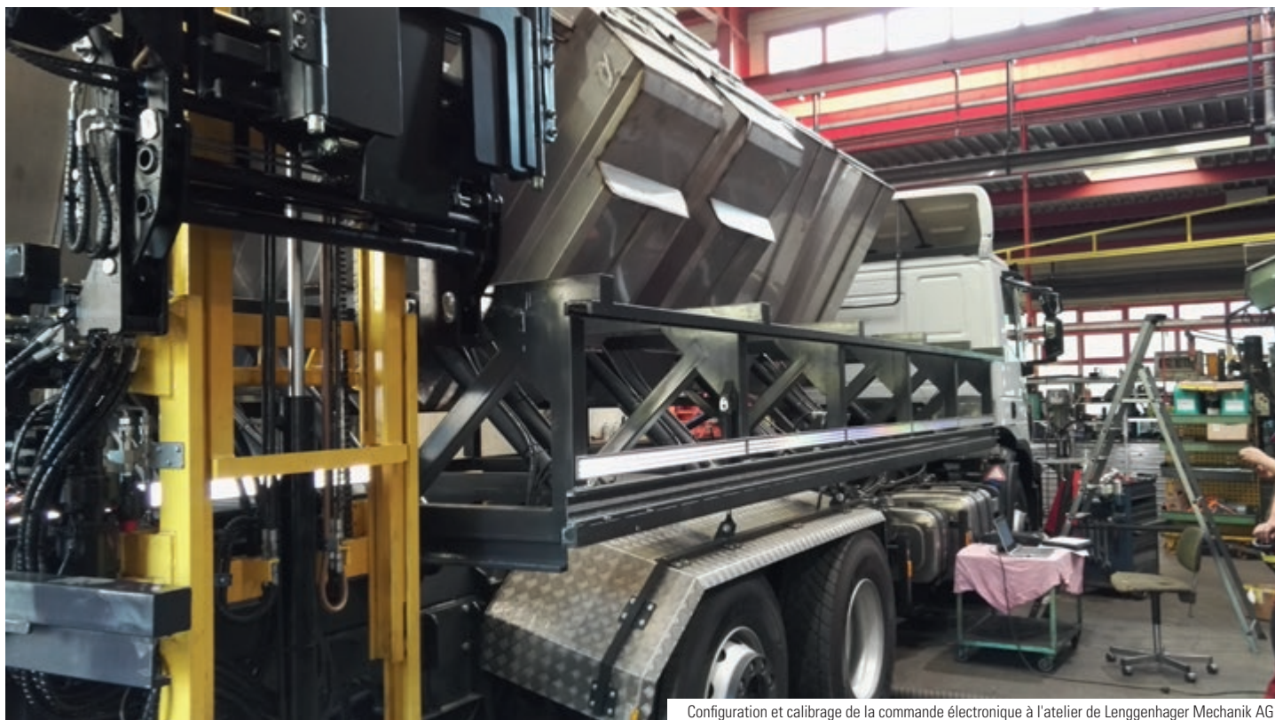
Configuration et calibrage de la commande électronique à l'atelier de Lenggenhager Mechanik AG
