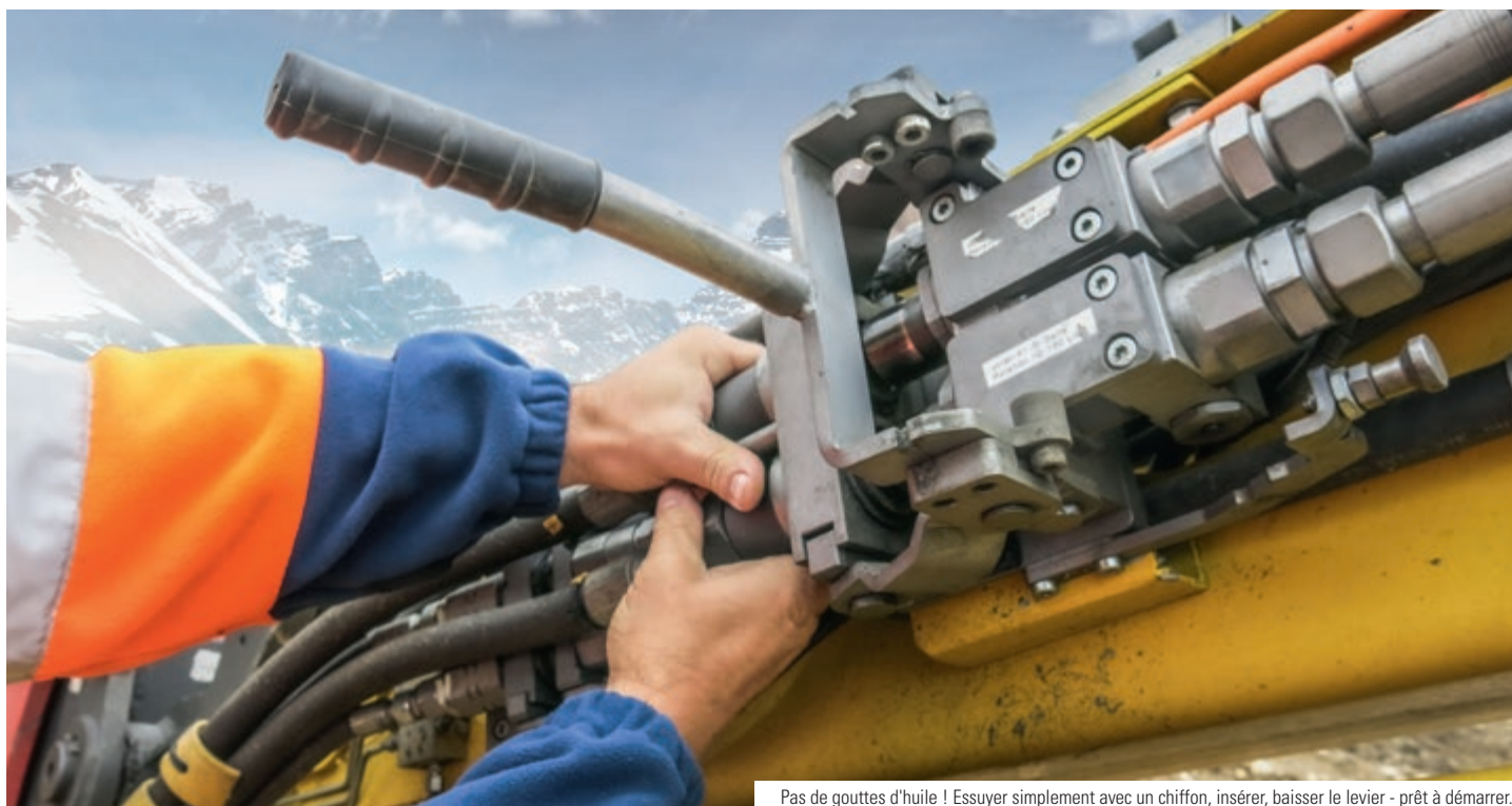
Pas de gouttes d'huile ! Essuyer simplement avec un chiffon, insérer, baisser le levier - prêt à démarrer.
