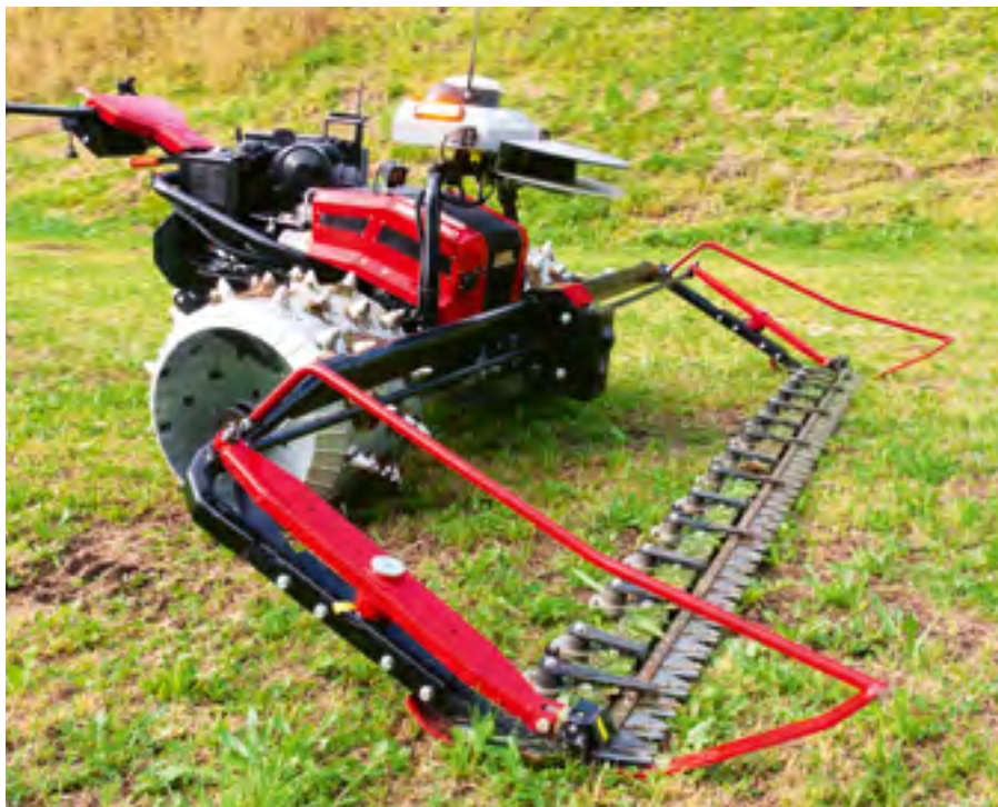
Grâce au système «SelfDrive», ce monoaxe «Gekko» de Köppl muni d'une barre de coupe en portique travaille désormais de façon autonome. Photos: Roman Engeler
