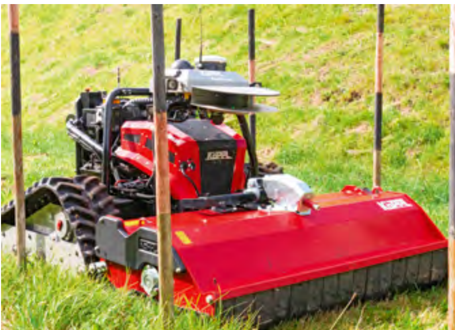
Le progiciel «RowCropPilot» fonctionne avec un scanner 3D à laser qui lui permet de s'orienter entre les cultures en rangs. Il est utilisé avec un «Crawler» sur la photo ci-dessus.
