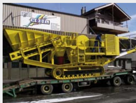
Une broyeuse de pierres entraînée par l'hydraulique
