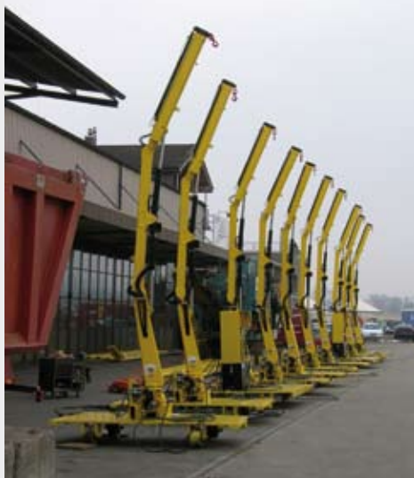
10 grues synchronisées lors de la construction de voies ferrées
