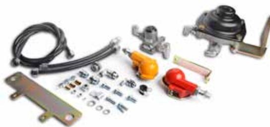
In den **TU 330** (Anhängerbremsen) finden Sie beispielsweise neu ein Abschaltventil für Bremsventile. Dies ist besonders nützlich wenn das hydraulische Anhängerbremseventil am Traktor nur bei gekuppelter Anhängerbremse-Kupplung aktiv werden soll.
