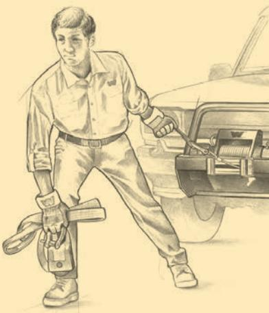
2.2 Jetzt den Freilaufhebel einkuppeln, dann sorgfältig das Seil spannen und anschliessend kann mit der Bergung begonnen werden. Es empfiehlt sich, bei elektrischen Winden den Motor des Fahrzeuges laufen zu lassen, damit die Batterie vom Alternator mit Strom versorgt wird.
