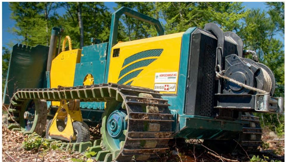
*Moteur Yanmar et composants Brevini Fluid Power: une combinaison intéressante de ce véhicule forestier à chenilles «HFR 504 Plus».*
