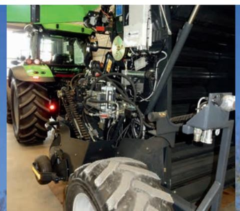
*Essieu TDS monté sur une presse à balles rondes Deutz Fahr.*
