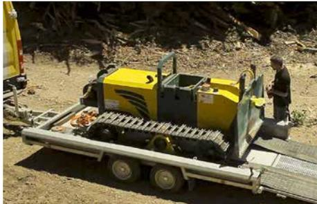
Ce véhicule s'appelle «HFR 504 Plus» et a été conçu pour le débardage forestier dans des endroits inaccessibles à des véhicules sur roues. On remarque sur la photo ci-dessous le cadre en tube permettant d'accrocher l'engin à chenilles avec une grue pour le charger facilement et rapidement. Ce véhicule est équipé d'un treuil forestier Adler EHY avec une capacité de traction de max. 5 t pouvant être télécommandé par radio. Le câble en acier d'un diamètre de 12 mm mesure 80 m.
