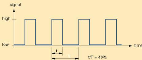
gesamten Periodendauer eingeschaltet bleiben. Je grösser die Zeit ist, in welcher der Schalter auf «Ein» steht (im Bild 40%), desto grösser wird das Spannungslevel. Bei bleibendem Widerstand der Magnetspule wird der Strom stärker und dadurch auch die Kraft des Magneten. Die Auslenkung des Ventils wird grösser oder im Falle eines Druckventiles steigt der Druck an.
