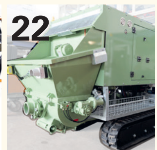
Betonpumpe von Specon AG
