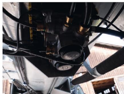
Blick auf die Steuerungseinheit der Multivoltage-Bremsanlage (12/24 V tauglich), platziert unter dem Fass und vor der Achse.
