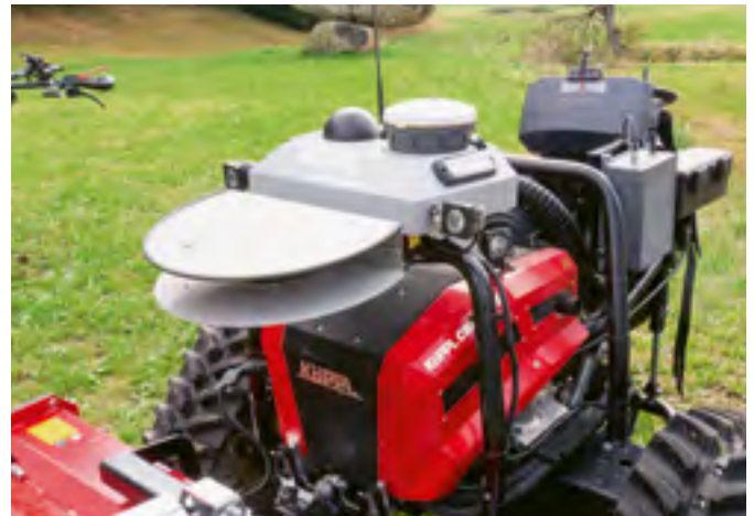
Die montierte Steuerungseinheit mit Funk- und GPS-RTK-Antenne sowie – geschützt – einem Laserscanner.
