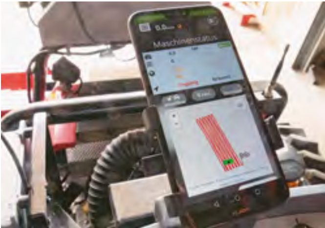
Auf dem Smartphone können die Arbeiten programmiert und dann auch überwacht werden.
