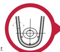
Mit 40% weniger erforderlicher Biegekraft und einem minimalen Biegeradius von 1/5 der SAE-Spezifikation ist dieser Schlauch noch schneller zu installieren und noch einfacher zu verlegen. Dies erhöht die Produktivität und schont gleichzeitig Ihre Mitarbeiter.
