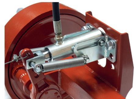
**Bremszylinder zu Druckluftkonsole:**
