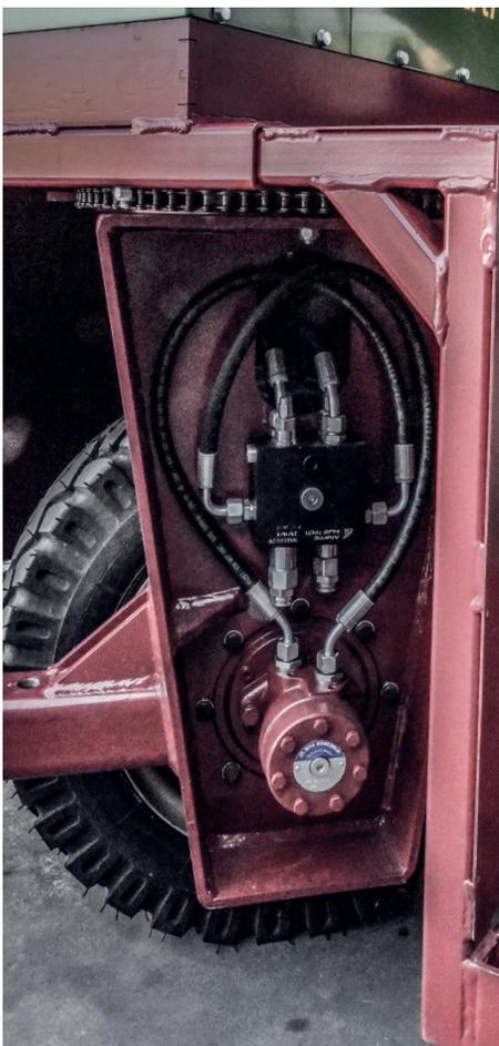
Fahrtrieb mit Motion-Controll Ventil
