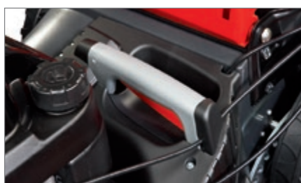
Système de réglage de la hauteur de coupe répondant à un levier en position pratique.
