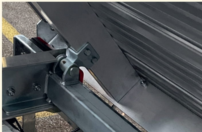
Abb. 5 Scharnier für Rückwärtskipper
