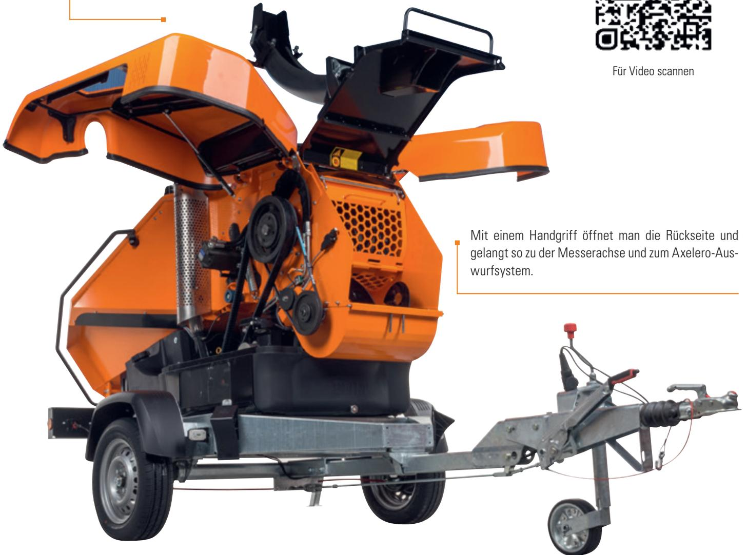
Mit einem Handgriff öffnet man die Rückseite und gelangt so zu der Messerachse und zum Axelero-Auswurfsystem.
